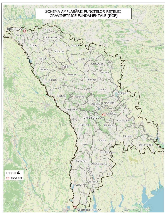
Schema amplasării punctelor rețelei gravimetrice fundamentale din Republica Moldova
